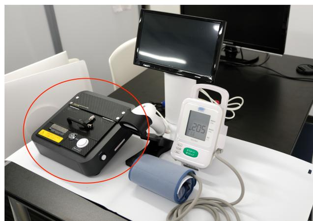
実装イメージ(AOBP 血圧測定補助装置、バーコードリーダー、モニター、他社の血圧計がセットで使われる)
